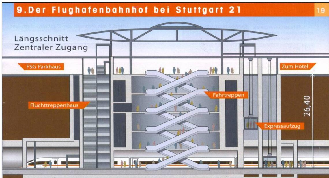
Längsschnitt durch den Flughafenbahnhof (aus „K21- die Alternative zu Stuttgart21“), ältere Darstellung, die aktuellen Pläne der DB sind derzeit noch nicht veröffentlicht.
